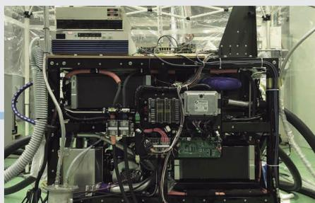
燃料電池システムの発電試験
