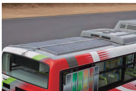
ソーラーパネル Solar PV panels
