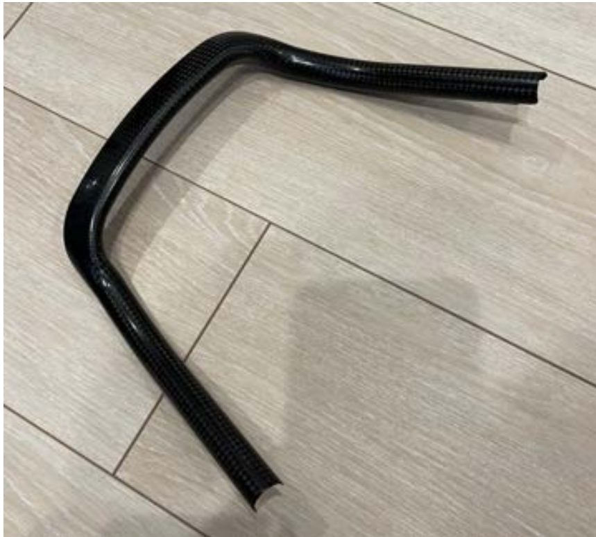
プリプレグオートクレーブ成形(CFRP) 成形時間(材料カットから脱型)：約300分
