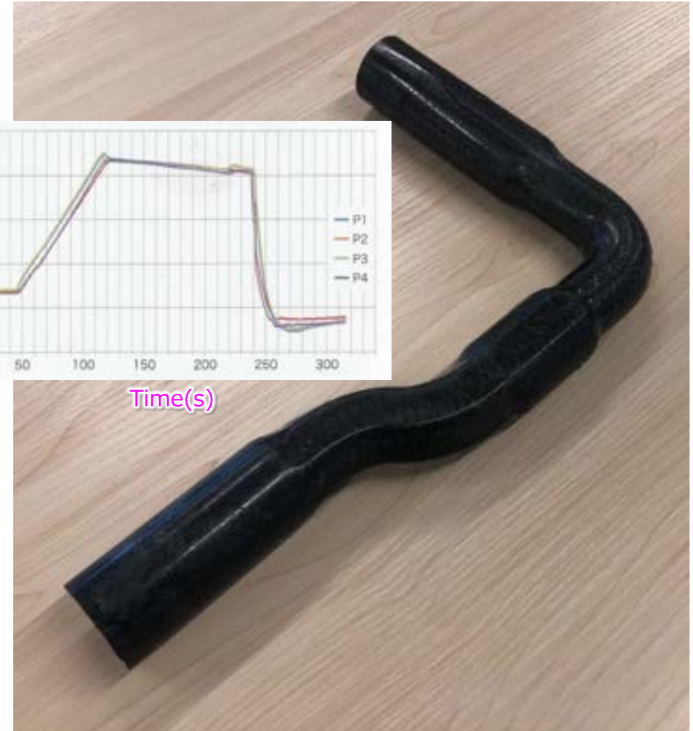
コニングル組紐内圧成形(CFRTP) 成形時間(材料カットから脱型)：約15分
