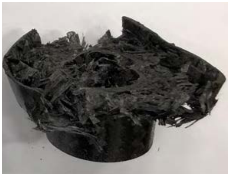
圧縮試験結果(CFRP)(ナイフエッジ有)
