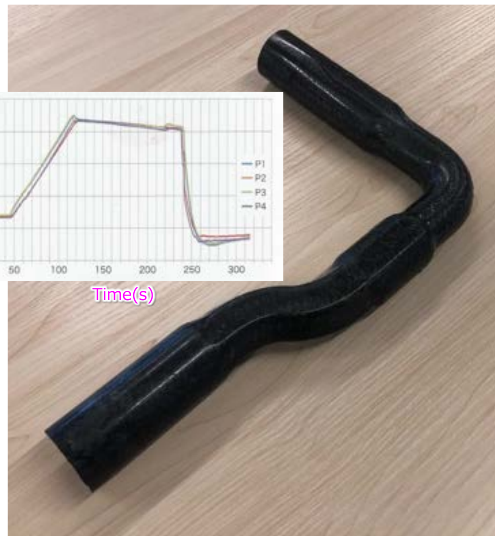
コニングル組紐内圧成形(CFRTP) 成形時間(材料カットから脱型)：約15分
