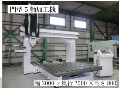
5軸加工機は自由度が高く、大型サイズの加工も対応できます。石膏ボードや樹脂製の成型、CFRPの加工はもちろん、発泡スチロールなどの加工実績もあります。大きなワークサイズを生かし、分割をなくした一体での加工も可能です。
