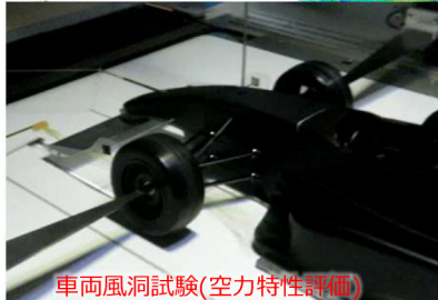
車両流体解析(空力特性評価)
