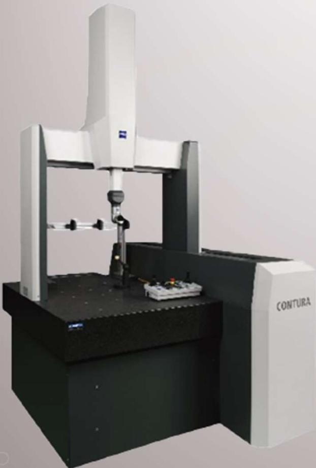
接触子により高精度で三次元形状を測定可能。
